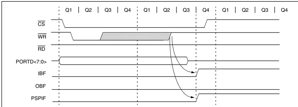
**FIGURE 10-4: PARALLEL SLAVE PORT READ WAVEFORMS**
