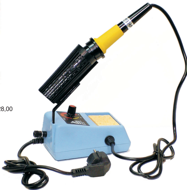
MLS48 SA REGULACIJOM TEMPERATURE 68,00 220 V, 50 W 200 - 450°C
