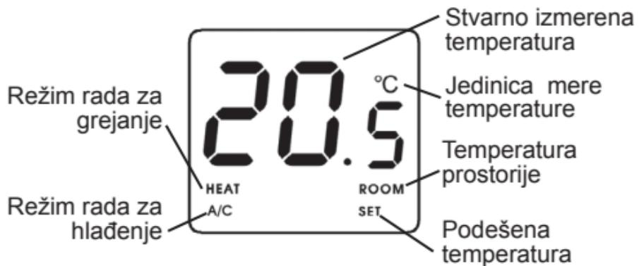
20,2°C ili iznad nje isključiti kotao (kod sistema hlađenja je obrnuto). Izmenu fabrički podešene osetljivosti uključenja od  $\pm 0,2^{\circ}\text{C}$  vidi pod tačkom 4.1.
