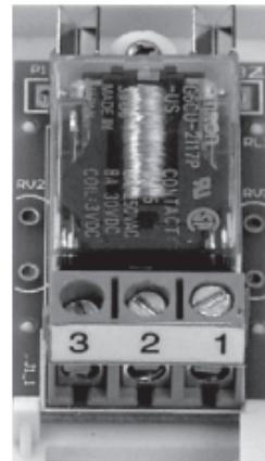
**PAŽNJA!** Kod priključenja obavezno treba uzeti u obzir mogućnost opterećenja releja termostata i uputstva proizvođača grejnog ili rashladnog uređaja! Priključenje prepustite stručnjaku!
